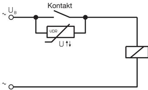
Beispiel: Kontaktschutzmaßnahme mit Spannungsabhängigem Widerstand VDR
