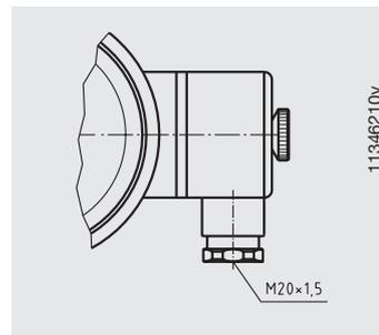
B Kabelanschlussdose aus PA 6, schwarz, Schutzart IP 65, Temperaturbeständigkeit -40 ... +80 °C, nach VDE 0110 Isolationsgruppe C/250 V, Kabelverschraubung M20 x 1,5 (nach unten abgehend), Zugentlastung, 4 Mantelklemmen + PE für Leiterquerschnitt 2,5 mm<sup>2</sup>, rechts am Gehäuse montiert
