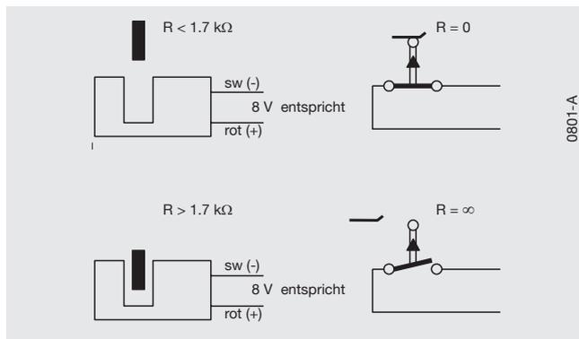
Die Steuereinheit arbeitet praktisch ohne Rückwirkung auf das Messsystem. Die berührungslose „Kontaktgabe“ erzeugt keinerlei Verschleiß im elektrischen System. Die Einbaumaße entsprechen denen des Kontakt-Typ 821. Einstellung der Sollwerte erfolgt wie bei diesen Kontakten.
